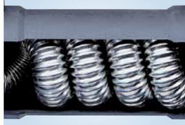
Die Wärmetauscher bestehen aus einem kompakt gewendelttem Edelstahl-Wellschlauch in einem hochwertigen Kunststoffgehäuse. Heizungsseitig sind zwei oder vier Gewindenippel in das Gehäuse eingelassen. Die Badewasserverrohrung erfolgt über eine PVC-Klebeverbindung. Zusätzlich verfügen alle Gehäuse über eine Tauchhülse zur Aufnahme eines elektrischen Temperaturfühlers.
